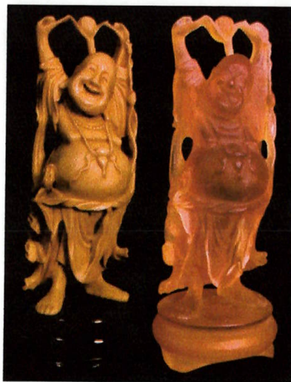
Fig. 1.1 - Exemplo de resultado conseguido pela técnica da estereolitografia. O modelo da esquerda foi digitalizado e reconstruído por camadas, resultando no modelo da direita
